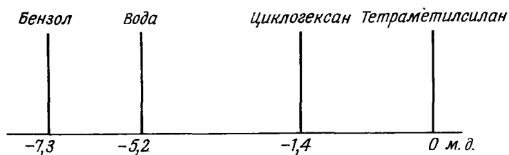
Р и с. 1.1. Химические сдвиги бензола, воды и циклогексана, измеренные относительно тетраметилсилана.
